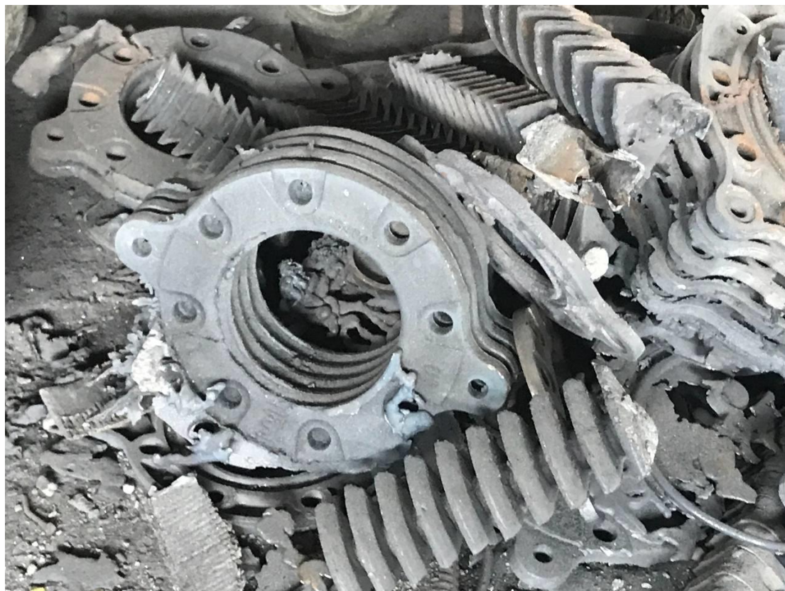
شکل ۱-۲- قطعات قبل از مرحله شات بلاست
